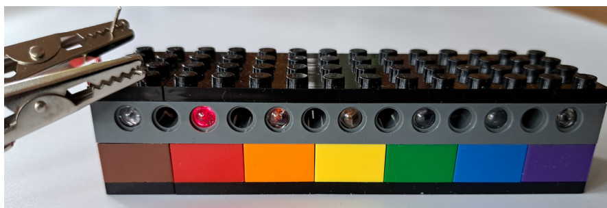
Abb. 8. LED an einer variablen Spannungsquelle eingestellt auf 1.75 V: Die Spannung reicht für das unsichtbare infrarote Licht und die rote LED, beim Erhöhen der Spannung beginnen die anderen der Reihe nach zu leuchten
