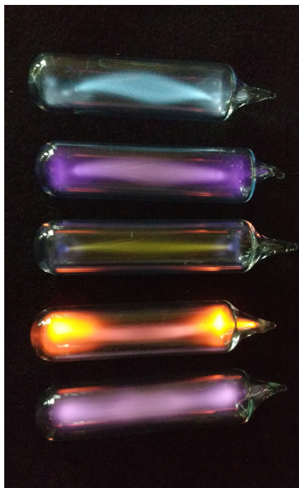
Abb. 6. Spektralfarben der Edelgase Xenon, Krypton, Argon, Neon und Helium. Sie sind in Glasampullen eingeschlossen und liegen auf zwei horizontal verlaufenden Drähten, welche das Hochspannung-Hochfrequenzfeld erzeugen.
